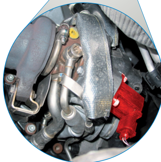
Valvola di ricircolo dell'aria in fase di rilascio nella VW EOS TFSI (evidenziata in rosso)
